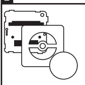
Entfernen Sie den Dreh-/Druckknopf vom Dimmer, indem Sie daran ziehen. Lösen Sie dann die Mutter und entfernen Sie die Rosette vom Dimmer.
