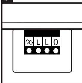
Die Klemmleiste ist nun zugänglich. An das rechte L und an die 0 kommen die Versorgungsdrähte. Verbinden Sie den braunen Draht mit dem rechten L und den blauen Draht mit der 0. Auf der linken Seite schließen wir die absteigende Seite an. Dann schließen Sie den schwarzen Draht an das Schaltzeichen (linke Seite) an. Und das braune Kabel an das linke L.
