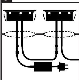
Verbinden Sie dann den nächsten Einbaustrahler, durch das Loch, mit dem ersten Einbaustrahler. Gehen Sie weiter so. Am Ende drücken Sie die LED Einbaustrahler in die Lochstelle.
