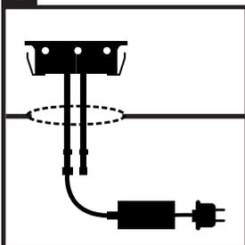
Bohren Sie die Löcher mit einer Lochsäge von 30 mm an die gewünschte Position. Schließen Sie den LED Einbaustrahler, durch das Loch, an den Stecker an.
