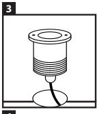
Bohren Sie die Löcher mit einer Lochsäge von 43 mm an die gewünschte Position. Der LED Bodeneinbaustrahler muss durch das Loch im Röhrchen platziert werden, bevor es an die Stromversorgung angeschlossen wird.
