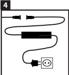
Verbinden Sie nun den Bodenstrahler mit dem einfachen Schraubsystem und dem Hamulight (astro) LED Transformator. Schließen Sie zum Schluss den Stecker des Transformators an eine Steckdose an.
