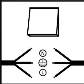
Schließen Sie zunächst die LED Wandleuchte an den Ein/Aus-Schalter. N = Kabel Blau, L = Kabel Braun und ⊕ = Kabel Gelb/Grün. Wir empfehlen Ihnen den Stromgenerator vorher auszuschalten!
