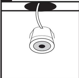
Bohren Sie die Löcher mit einem Sägemeiß von 28 mm auf der gewünschten Position. Positionieren Sie zunächst die Kabel der LED Einbaustrahler an der gewünschten Stelle. Bringen Sie den LED Einbaustrahler an dem Bohrloch an. Bringen Sie den Einbaustrahler in Position, der Strahler klemmt sich mit den Federn ein.
