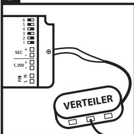
Schließen Sie alle Einbaustrahler am Verteiler. Die Stecker müssen alle mit dem Verteiler verbunden werden, weil die Beleuchtung geschaltet ist. Falls der Verteiler mehr Anschlüsse hat als die Anzahl der gelieferten Einbaustrahler, positionieren Sie eine Steckbrücke (Schwarze Steckbrücke) in die übrige(n) Öffnung(en). Diese Steckbrücke(n) wird/werden (je nach Anzahl der Einbaustrahler und Typ des Verteiler) mitgeliefert.
