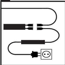
Verbinden Sie nun den LED-Streifen mit dem Somfy io veranda LED-Empfänger. Dies geschieht durch Verbinden der Koppler. Haben Sie mehrere LED-Streifen? Dann müssen Sie die LED-Streifen mit dem Kabelanschluss verbinden, den Sie zuvor an den Somfy io veranda LED-Empfänger angeschlossen haben.
