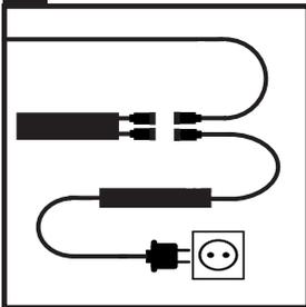
Verbinden Sie nun den LED-Streifen mit dem wifi veranda LED-Empfänger. Dies geschieht durch Verbinden der Koppler. Haben Sie mehrere LED-Streifen? Dann müssen Sie die LED-Streifen mit dem Kabelanschluss verbinden, den Sie zuvor an den wifi veranda LED-Empfänger angeschlossen haben.
