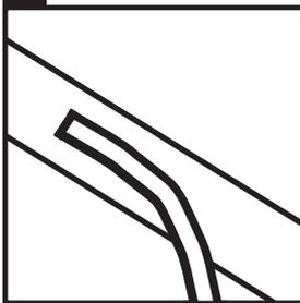
Positionieren Sie den LED-Streifen an die gewünschte Stelle. Entfernen Sie das 3M-Band vom LED-Streifen und kleben Sie es an das Profil.
