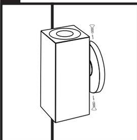
Befestigen Sie die Wandleuchte mit den 2 Schrauben am Sockel.
