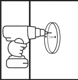
Befestigen Sie die Halterung mit zwei Schrauben an die gewünschte Stelle an der Wand.
