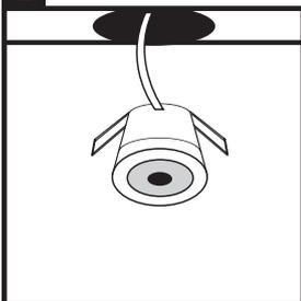
Bohren Sie die Löcher mit einem Sägemeiß von 35 mm auf der gewünschten Position. Positionieren Sie zunächst die Transformator der LED Einbaustrahler an der gewünschten Stelle. Bringen Sie den LED Einbaustrahler an dem Bohrloch an. Drücken Sie anschließend beide Federn hoch und schieben Sie den in die gewünschte Stellung.
