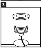
Bohren Sie die Löcher mit einer Lochsäge von 85 mm an die gewünschte Position. Der LED Bodeneinbaustrahler muss durch das Loch im Röhrchen platziert werden, bevor es an die Stromversorgung angeschlossen wird. Wir empfehlen, das Stromkabel mindestens 50 cm unter dem Boden zu verlegen.
