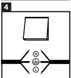
Schließen Sie zunächst den LED Bodeneinbaustrahler an die Stromversorgung. N = Kabel Blau,  $L = \text{Kabel Braun und } \oplus = \text{Kabel Gelb/Grün}$ . Wir empfehlen Ihnen den Stromgenerator vorher auszuschalten!
