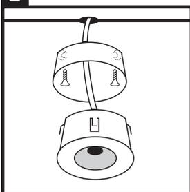
Bohren Sie die Löcher auf der gewünschten Position in Ihrer Veranda. Positionieren Sie zunächst die Kabel der LED Aufbaustrahler an der gewünschten Stelle. Bringen Sie die Kabel an dem Bohrloch an, und schrauben Sie den Einbau in das Profil und klicken Sie der LED Aufbaustrahler in den Einbau.
