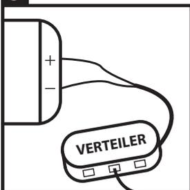
Verbinden Sie alle Aufbaustrahler mit dem Verteiler. Die verbleibenden Anschlüsse sollten nicht aufgefüllt werden. Das Set wird parallel geschaltet.
