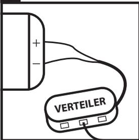
Nachdem verbinden Sie alle Aufbaustrahler mit dem Verteiler. Die Stecker müssen alle mit dem Verteiler verbunden werden, weil die Beleuchtung Serie-geschaltet ist. Falls der Verteiler mehr Anschlüsse hat als die Anzahl der gelieferten Aufbaustrahler, positionieren Sie eine Steckbrücke (Schwarze Steckbrücke) in die übrige(n) Öffnung(en). Diese Steckbrücke(n) wird/werden (je nach Anzahl der Aufbaustrahler und Typ des Verteiler) mitgeliefert.
