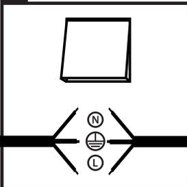
Schließen Sie zunächst den LED Bodeneinbaustrahler an die Stromversorgung. N = Kabel Blau, L = Kabel Braun und  $\oplus$  = Kabel Gelb/Grün. Wir empfehlen Ihnen den Stromgenerator vorher auszuschalten!
