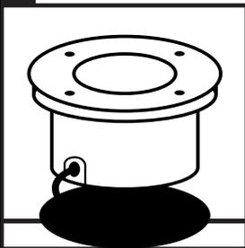
Bohren Sie die Löcher mit einer Lochsäge von 75 mm auf die gewünschte Position. Bringen Sie den LED Bodeneinbaustrahler an die Bohrstelle an. Wir empfehlen, das Stromkabel mindestens 50 cm unter dem Boden zu verlegen.
