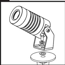
Montieren Sie den Erdspieß an den Strahler mit den mitgelieferten Schrauben.
