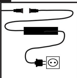
Verbinden Sie nun den Erdspießstrahler mit dem einfachen Schraubsystem und dem Hamulight (astro) LED Transformator. Schließen Sie zum Schluss den Stecker des Transformators an eine Steckdose an.
