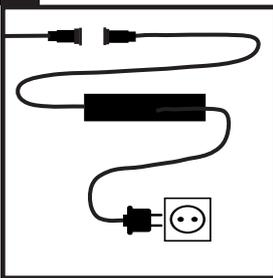
Verbinden Sie nun die Wegeleuchte mit dem einfachen Schraubsystem und dem Hamulight (astro) LED Transformator. Schließen Sie zum Schluss den Stecker des Transformators an eine Steckdose an.
