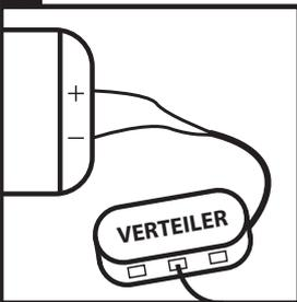
Verbinden Sie alle Einbaustrahler mit dem Verteiler. Die verbleibenden Anschlüsse sollten nicht aufgefüllt werden. Das Set wird parallel geschaltet.
