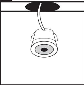
Bohren Sie die Löcher mit einem Sägemmaß von 22 mm auf der gewünschten Position in Ihrer Veranda. Positionieren Sie zunächst die Kabel der LED Einbaustrahler an der gewünschten Stelle. Bringen Sie den LED Einbaustrahler an dem Bohrloch an, damit die zwei Federn den Tragbalken der Veranda nicht berühren. Bringen Sie den Einbaustrahler in Position, der Strahler klemmt sich mit den Federn ein.
