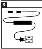
Verbinden Sie nun die Wandleuchte mit dem einfachen Schraubsystem und dem Hamulight (astro) LED Transformator. Schließen Sie zum Schluss den Stecker des Transformators an eine Steckdose an.
