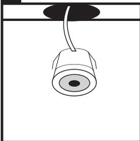
Bohren Sie die Löcher mit einem Sägemeiß von 30 mm auf der gewünschten Position. Positionieren Sie zunächst die Kabel der LED Einbaustrahler an der gewünschten Stelle. Bringen Sie den LED Einbaustrahler an dem Lochsäge an. Bringen Sie den Einbaustrahler in Position, der Strahler klemmt sich mit den Federn ein.
