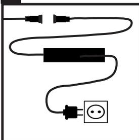
Verbinden Sie nun die Wandleuchte mit dem einfachen Schraubsystem und dem Hamulight (astro) LED Transformator. Schließen Sie zum Schluss den Stecker des Transformators an eine Steckdose an.
