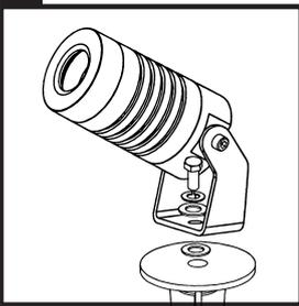
Montieren Sie den Erdspeiß an den Strahler mit den mitgelieferten Schrauben.
