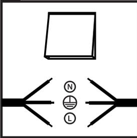
Schließen Sie zunächst die LED Wandleuchte an den Ein/Aus-Schalter. N = Kabel Blau, L = Kabel Braun und  $\oplus$  = Kabel Gelb/Grün. Wir empfehlen Ihnen den Stromgenerator vorher auszuschalten!
