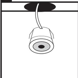
Bohren Sie die Löcher mit einem Sägemmaß von 35 mm auf der gewünschten Position in Ihrer Veranda. Positionieren Sie zunächst die Kabel der LED Einbaustrahler an der gewünschten Stelle. Bringen Sie den LED Einbaustrahler an dem Bohrloch an, damit die zwei Federn den Tragbalken der Veranda nicht berühren. Bringen Sie den Einbaustrahler in Position, der Strahler klemmt sich mit den Federn ein.
