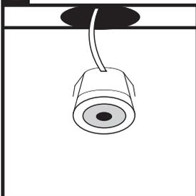
Bohren Sie die Löcher mit einem Sägemeiß von 35 mm auf der gewünschten Position. Positionieren Sie zunächst die Kabel der LED Einbaustrahler an der gewünschten Stelle. Bringen Sie den LED Einbaustrahler an dem Bohrloch an. Bringen Sie den Einbaustrahler in Position, der Strahler klemmt sich mit den Federn ein.
