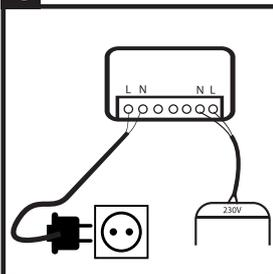
Schließen Sie nun den Hamulight Wifi LED-Empfänger an den Transformator an. Braun an L und blau an N. Zum Schluss schließen Sie das Festnetz an den Hamulight Wifi LED-Empfänger an. Braun an L und blau an N. Wir empfehlen, die Stromgruppe vorher auszuschalten!
