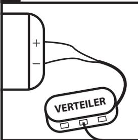
Nachdem verbinden Sie alle Einbaustrahler mit dem Verteiler. Die Stecker müssen alle mit dem Verteiler verbunden werden, weil die Beleuchtung Serie-geschaltet ist. Falls der Verteiler mehr Anschlüsse hat als die Anzahl der gelieferten Einbaustrahler, positionieren Sie eine Steckbrücke (Schwarze Steckbrücke) in die übrige(n) Öffnung(en). Diese Steckbrücke(n) wird/werden (je nach Anzahl der Einbaustrahler und Typ des Verteiler) mitgeliefert.
