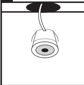
Bohren Sie die Löcher mit einem Sägemaß von 35 mm auf der gewünschten Position. Positionieren Sie zunächst die Kabel der LED Einbaustrahler an der gewünschten Stelle. Bringen Sie den LED Einbaustrahler an dem Lochsäge an. Bringen Sie den Einbaustrahler in Position, der Strahler klemmt sich mit den Federn ein.
