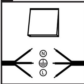
Schließen Sie zunächst die LED Wegeleuchte an den Ein/Aus-Schalter. N = Kabel Blau, L = Kabel Braun und  $\oplus$  = Kabel Gelb/Grün. Wir empfehlen Ihnen den Stromgenerator vorher auszuschalten!
