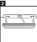
Befestigen Sie die Unterseite des Tarifa Aufbaustrahlers mit den 2 Schrauben am Träger. Bohren Sie in der Mitte ein Loch für die Kabeldurchführung. Legen Sie das Oberteil des Tarifa-Strahlers auf die montierte Unterseite. Diese ist magnetisch, so dass der Strahler auf diese Weise an der Unterseite bleibt.
