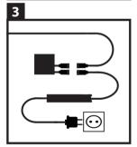
Verbinden Sie nun den Tarifa Strahler mit dem 24 Volt wifi veranda LED Empfänger. Dies geschieht durch Verbinden der Kuppler. Haben Sie mehrere Tarifa-Strahler? Dann müssen Sie die Strahler mit dem Kabelstecker verbinden, den Sie zuvor an den wifi veranda LED Empfänger angeschlossen haben.
