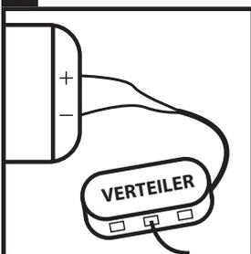
Nachdem verbinden Sie alle Einbaustrahler mit dem Verteiler. Die Stecker müssen alle mit dem Verteiler verbunden werden, weil die Beleuchtung geschaltet ist. Falls der Verteiler mehr Anschlüsse hat als die Anzahl der gelieferten Einbaustrahler, positionieren Sie eine Steckbrücke (Schwarze Steckbrücke) in die übrige(n) Öffnung(en). Diese Steckbrücke(n) wird/werden (je nach Anzahl der Einbaustrahler und Typ des Verteiler) mitgeliefert.
