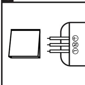
Betreiben Sie zunächst den Transformator am 230V (INPUT). ← = Kabel grün/gelb, N = Kabel blau und L = Kabel braun. Wir beraten Sie den Stromgenerator vorher auszuschalten! Falls Sie die Beleuchtung am Feststrom betreiben möchten, verbinden Sie den INPUT des Transformators mit dem Ein/Aus-Schalter (Feststrom)
