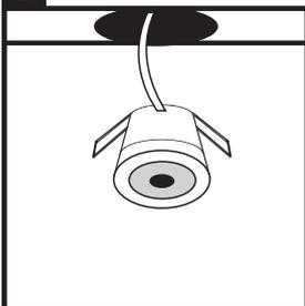
Bohren Sie die Löcher mit einem Sägemmaß von 42 mm auf der gewünschten Position. Positionieren Sie zunächst die Kabel der LED Einbaustrahler an der gewünschten Stelle. Bringen Sie den LED Einbaustrahler an dem Bohrloch an. Drücken Sie anschließend beide Federn hoch und schieben Sie den in die gewünschte Stellung.
