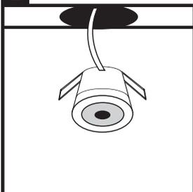
Bohren Sie die Löcher mit einem Sägemeiß von 42 mm auf der gewünschten Position. Positionieren Sie zunächst die Transformator der LED Einbaustrahler an der gewünschten Stelle. Bringen Sie den LED Einbaustrahler an dem Bohrloch an. Drücken Sie anschließend beide Federn hoch und schieben Sie den in die gewünschte Stellung.
