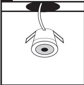
Bohren Sie die Löcher mit einem Sägemaß von 30 mm auf der gewünschten Position. Positionieren Sie zunächst die Kabel der LED Einbaustrahler an der gewünschten Stelle. Bringen Sie den LED Einbaustrahler an dem Lochsäge an. Drücken Sie anschließend beide Federn hoch und schieben Sie den in die gewünschte Stellung.
