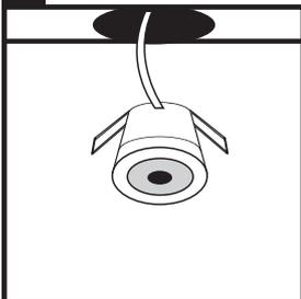
Bohren Sie die Löcher mit einem Sägemeiß von 30 mm auf der gewünschten Position. Positionieren Sie zunächst die Kabel der LED Einbaustrahler an der gewünschten Stelle. Bringen Sie den LED Einbaustrahler an dem Bohrloch an. Drücken Sie anschließend beide Federn gegen den Einbaustrahler an und schieben Sie den in die gewünschte Stellung.
