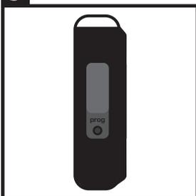
Wenn der io-Empfänger an die Stromversorgung angeschlossen ist, wählen sie den entsprechende kanal. Drücken Sie dann beide Pfeile auf der Fernbedienung, bis sich die Beleuchtung einschaltet, und drücken Sie dann einmal die PROG-Taste auf der Rückseite der Fernbedienung. die Beleuchtung ist nun eingelernt.
