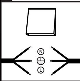
Schließen Sie zunächst die LED Wandleuchte an den Ein/Aus-Schalter. N = Kabel Blau, L = Kabel Braun und
